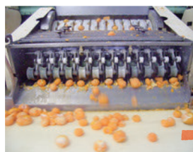
外皮を剥きやすくするため蒸し、機械で剥くが、ところどころ外皮が残ってしまう
