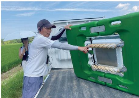
がよくわかりました。庄内自然エネルギー発電基金による助成で購入したアイガモロボ（写真）は現在、遊佐と酒田の2カ所で使用され、太陽光発電が動力となりGPSによって田んぼのどこを通ったか履歴も残ります。
