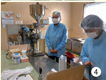
①水分を減らした、ペースト状の脱水ケーキ ②新しい原料選別機 ③使い込まれている焙煎機 ④手作業で、奥のロートからなたね油を缶に充てん。箱詰めして出荷される
