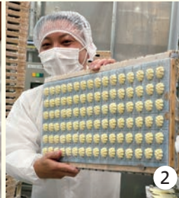
① 型取りのためのコーンスターチと木枠 ② ゼリーの型。①に押しつけて凹型をつくりそこにゼリーの果汁を流し込む ③ できあがったゼリー ④ 3段階の検品をしているところ *エアータック：圧縮した空気ですゼリー以外のごみを飛ばし見やすくして検品する。
